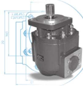
Насосы серии «F» состоят из литого корпуса и крышки, выполненных из высокопрочного алюминиевого сплава. Два компенсатора, выполненные из латунного сплава, обеспечивают высокую износостойкость, а металлофторопластовые подшипники обеспечивают повышенный ресурс работы насоса.
