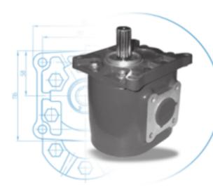
Насосы серии «G» изготавливаются со сквозным равнопрочным корпусом из алюминиевого сплава, исключающим возможность перекоса качающего узла, что обеспечивает стабильную работу насоса на протяжении всего срока службы.
